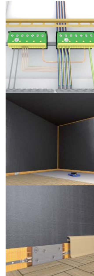
Bild 6: Anschluss im Kleinverteiler – FPA- und PE-Schiene mit Kennzeichnung und Verbindung zur Haupterdungsschiene
