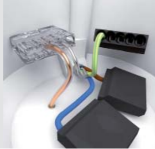
Bild 1: Verdrahtungsschema „Geschirmte Elektroinstallation“
